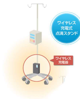
ワイヤレス給電(受電)設備
